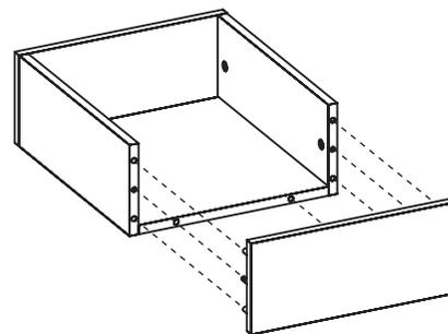
Encaixe a outra frente ou fundo restante na base e laterais através das cavilhas e minifix pré-colocados
