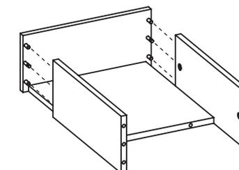
Encaixe e fixe as laterais na frente/fundo através das cavilhas e minifix pré-colocados
