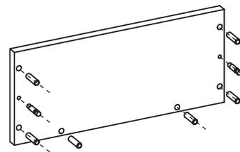
Instalar cavilhas **D** na Frente/Fundo, em seguida fixe os pinos minifix autoatarraxante **B**
