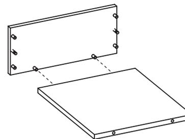
Encaixe uma frente ou fundo na base através das cavilhas pré-colocadas
